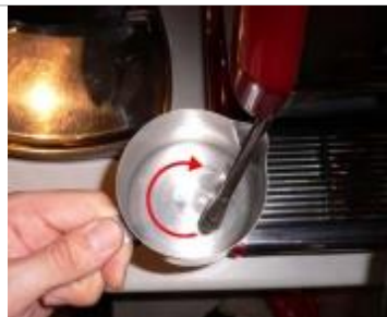
Optimale Lanzenposition (roter Pfeil=Sollbewegung der Milch)
